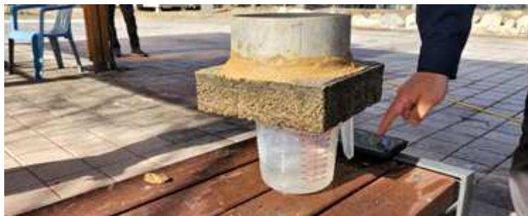
[분리 후 고압세척한 블록의 투수성능 시험]
