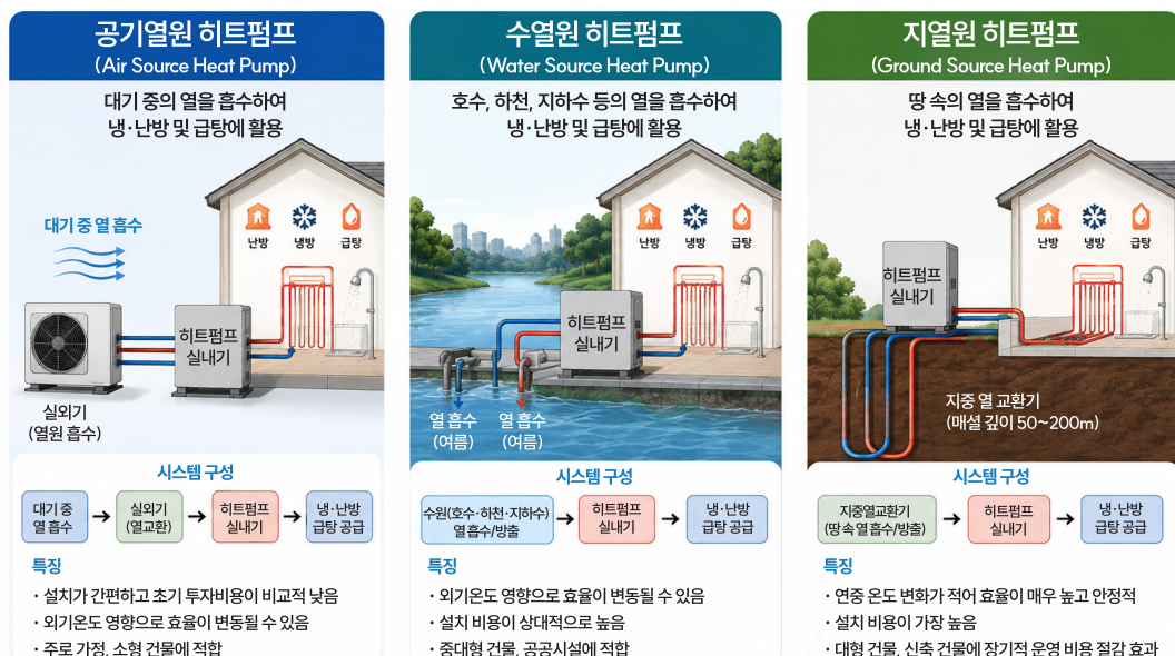
그림-3 채열원에 따른 히트펌프 종류 및 특징
