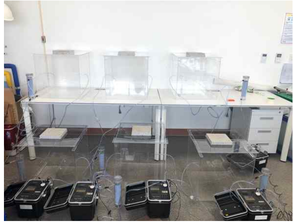
[그림 3-4] 실험시편 표면 라돈 방출량 측정
