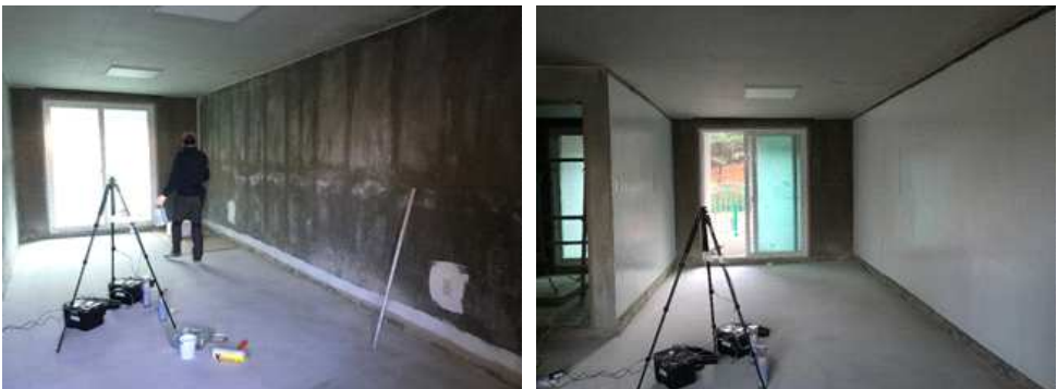
그림 5 실증주택 도료 시공 및 실내 라돈 농도 측정
