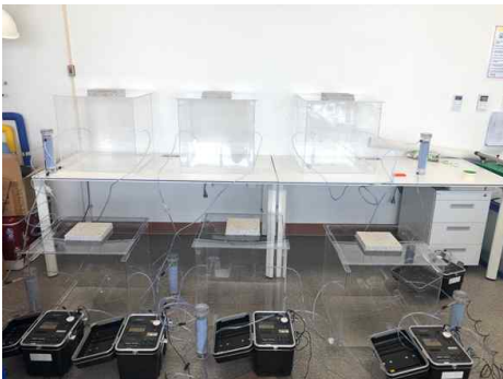
그림 2 실험시편 표면 라돈 방출량 측정
