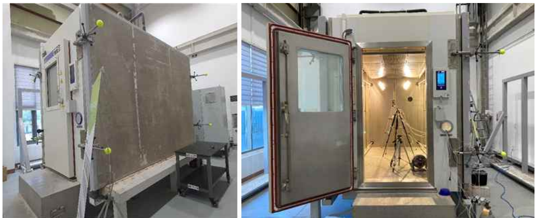
[그림 4-18] 외단열 실험 챔버를 이용한 실물 벽체 크기 시편 실험 준비
