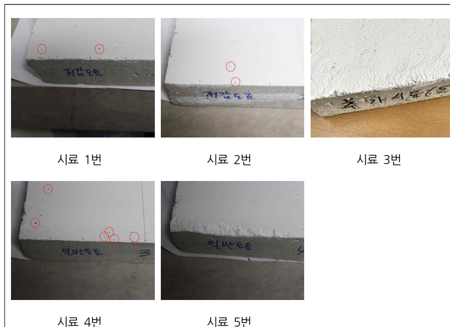
[그림 3-13] 도료를 도장한 콘크리트 시료의 표면 육안 관찰
