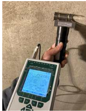
[그림 4-17] 시편의 표면 습도 측정
