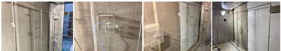
[그림 4-19] 실물 벽체 크기 시편에 부착한 소형 챔버 모습
