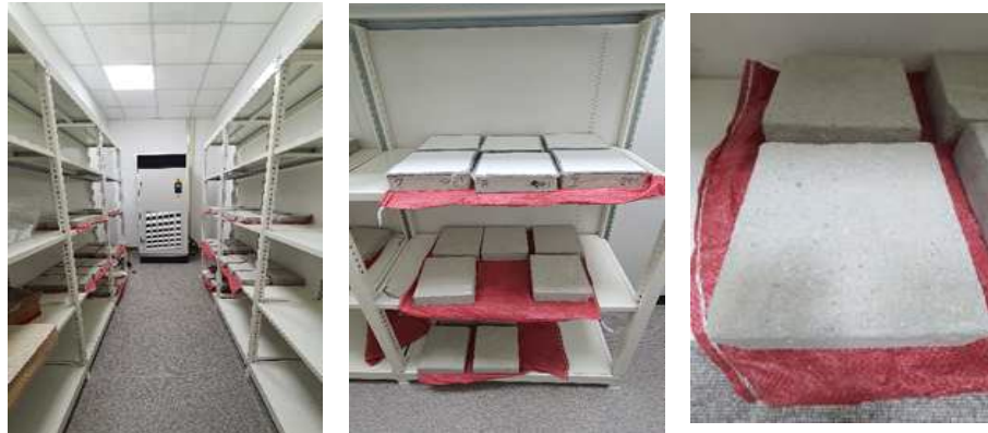
[그림 4-3] 항온항습실 내 콘크리트 시편 준비
