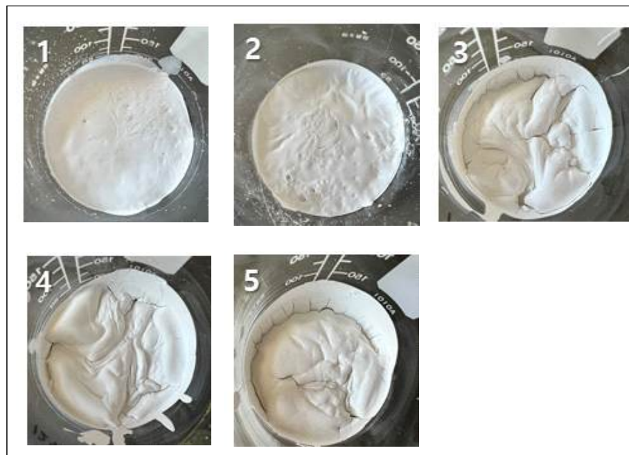
[그림 3-3] 고온 건조 상태에서의 시료 표면
