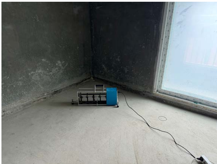
(b) 경량충격원(태핑머신) [그림 3-5] 바닥충격음 측정을 위한 표준충격원
