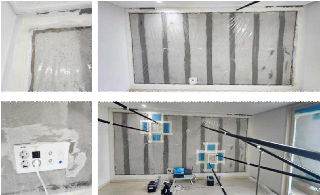
[그림 4-72] PE 필름 시공 후 벽체 표면 라돈 방출량 측정
