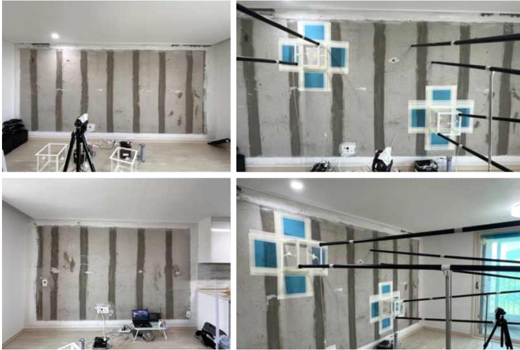
[그림 4-66] 벽지 철거 후 벽체 표면 라돈 방출량 측정
