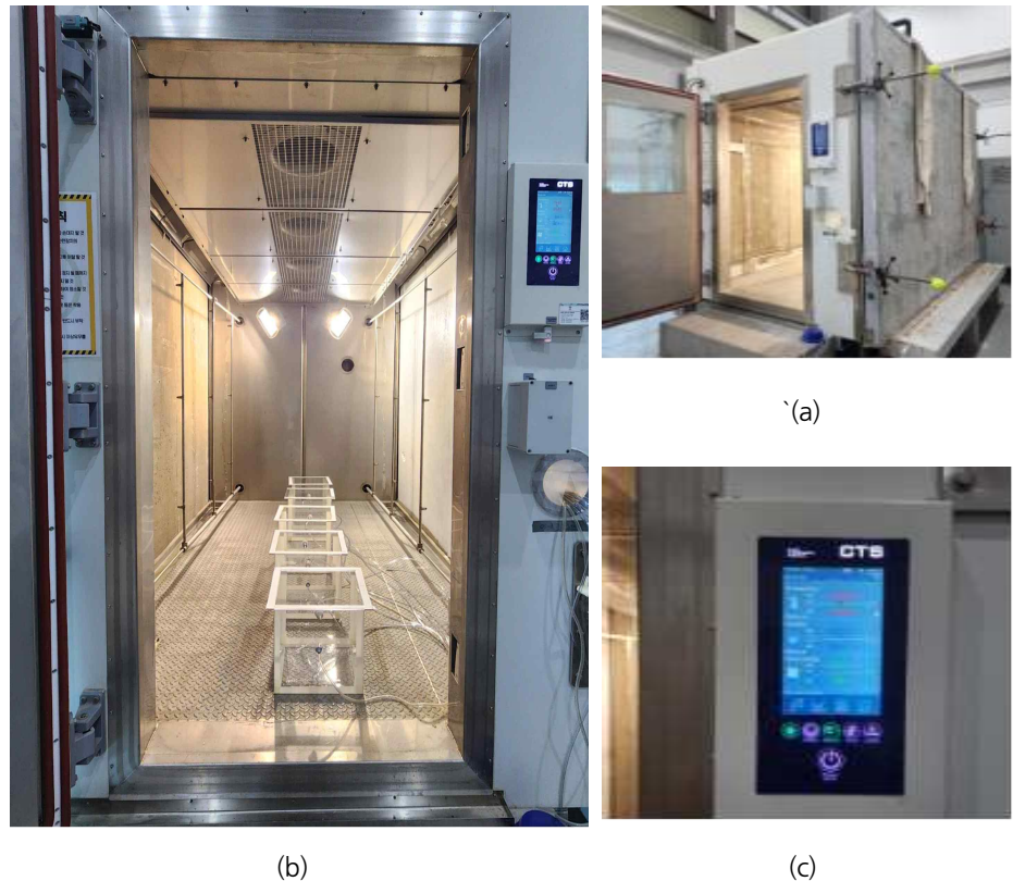
[그림 4-29] LH 주택성능연구개발센터 內 외단열 기후변화 챔버 Mock-up
