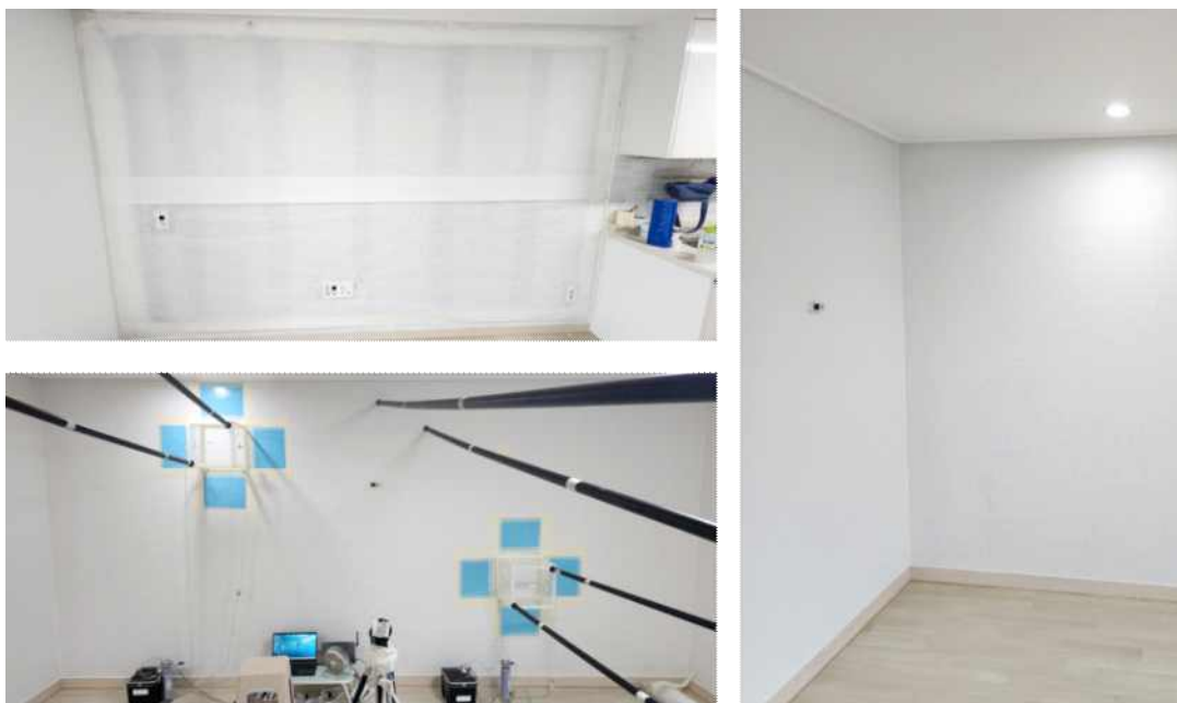
[그림 4-78] PE 필름 및 벽지 시공 후 벽체 표면 라돈 방출량 측정
