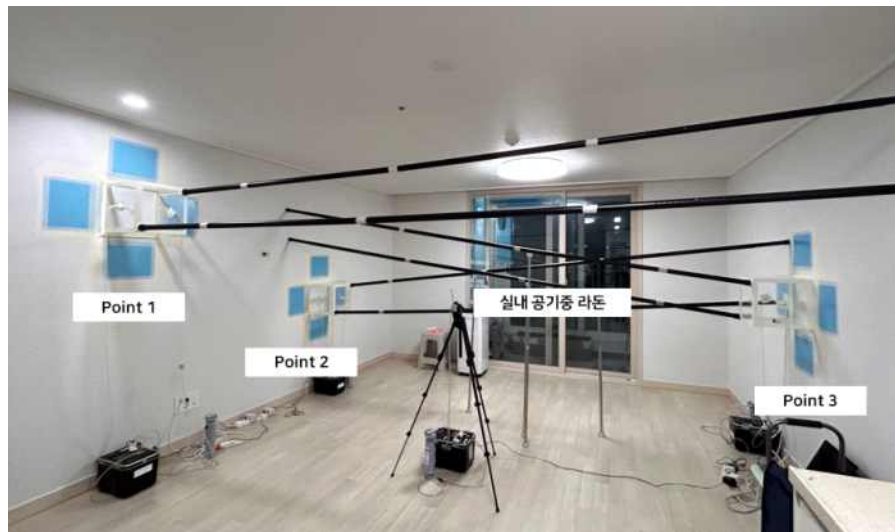
[그림 4-62] 기존 벽체 표면 라돈 방출량 측정
