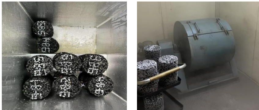
[그림 3.18] 저온 칸타브로 손실률 시험 수행절차
