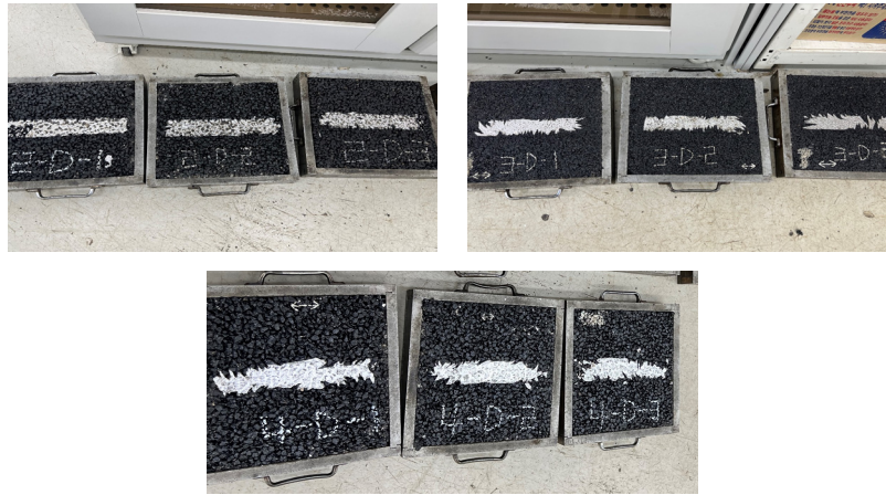
[그림 3.12] 휠 트래킹 시험 후 공시체
