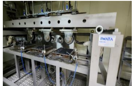
[그림 3.10] 동적안정도 시험 과정
