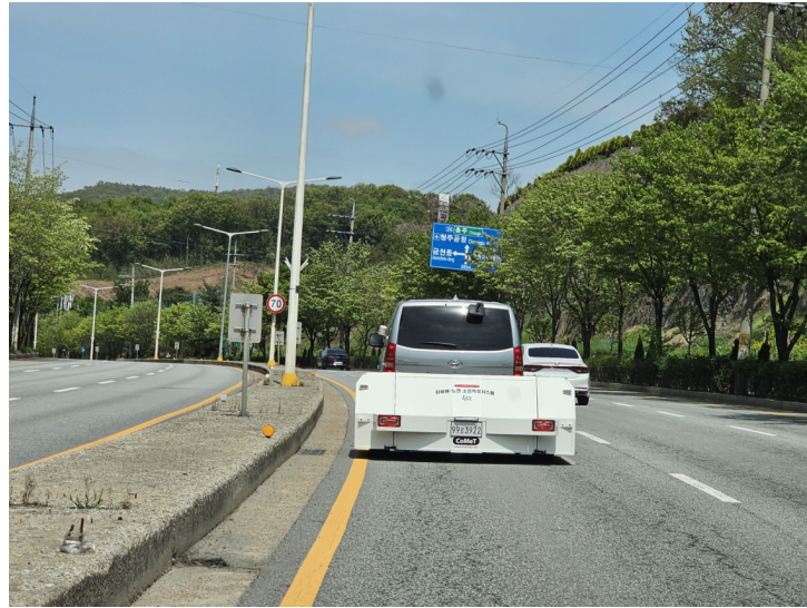
[그림 4.4] CPX 장비를 이용한 소음 측정
