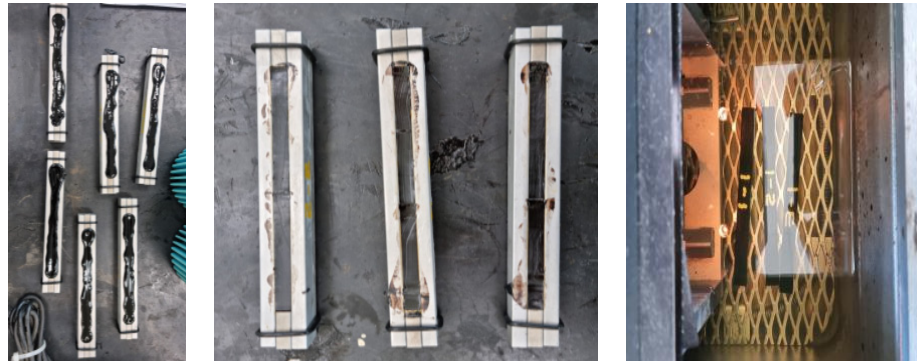
[그림 3.4] BBR 시험편 준비 과정
