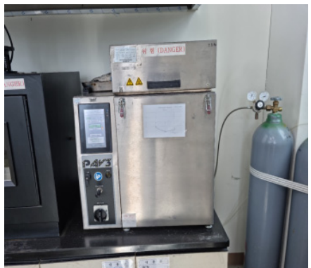
[그림 3.3] RTFO 시험장비(왼쪽) 및 PAV 시험장비(오른쪽)
