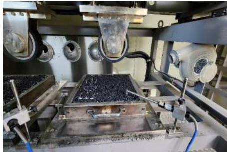
[그림 3.10] 동적안정도 시험 과정
