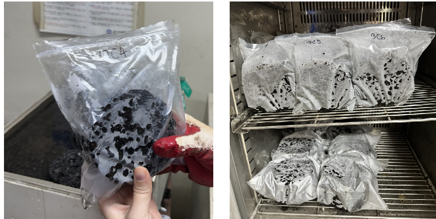
[그림 3.8] 인장강도비 시험 과정
