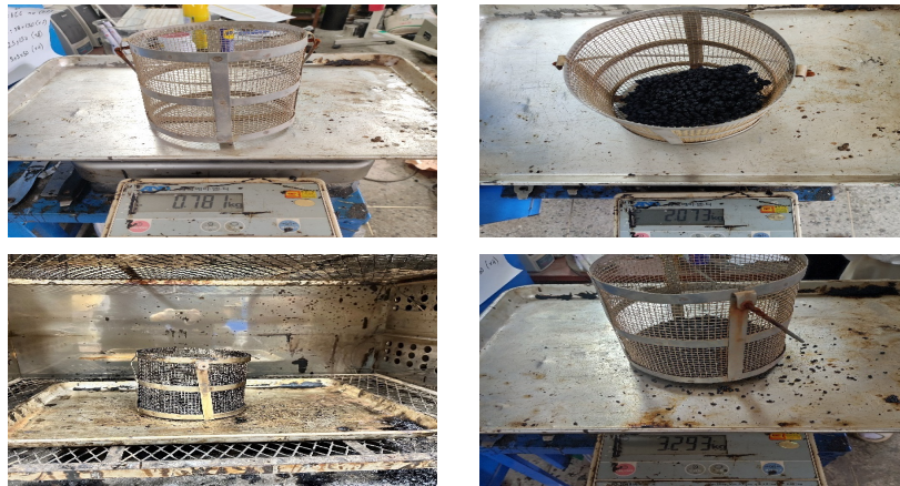
[그림 3.14] 드레인 다운 시험 과정
