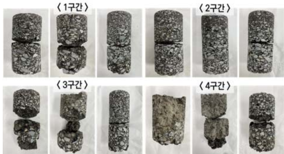
[그림 3.16] 구간별 코어 채취 모습
