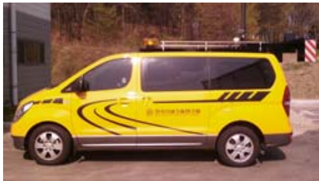
[그림 2.4] 노면 상태 조사 장비
