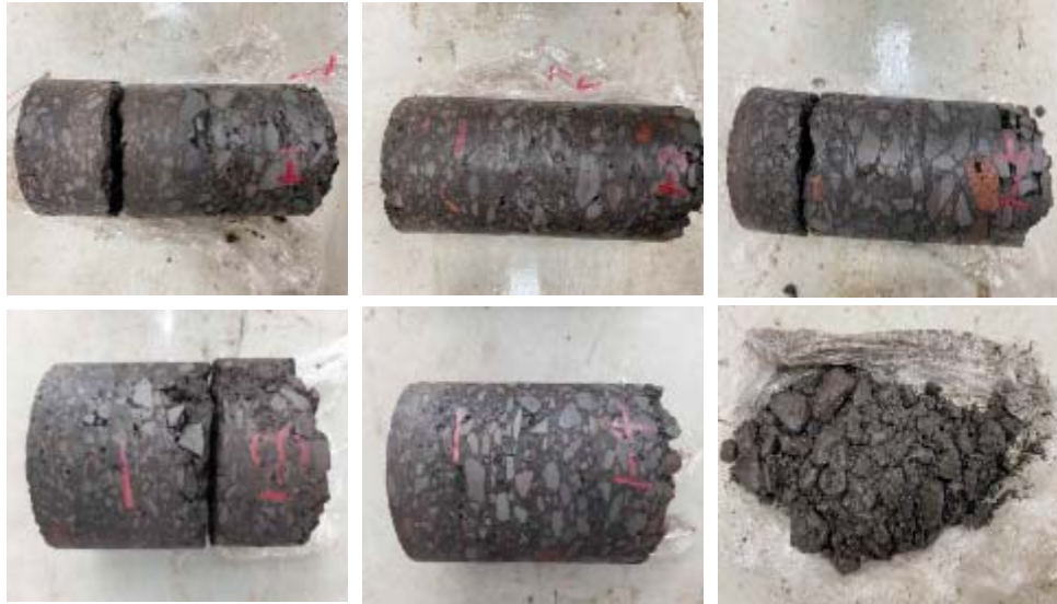
[그림 2.5] 코어 채취 및 상태 평가 모습
