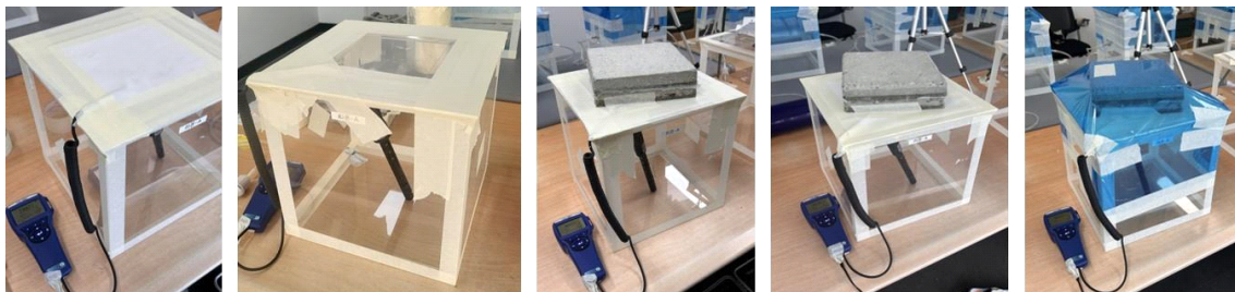
[그림 3-26] 챔버 기밀도 측정 장면
