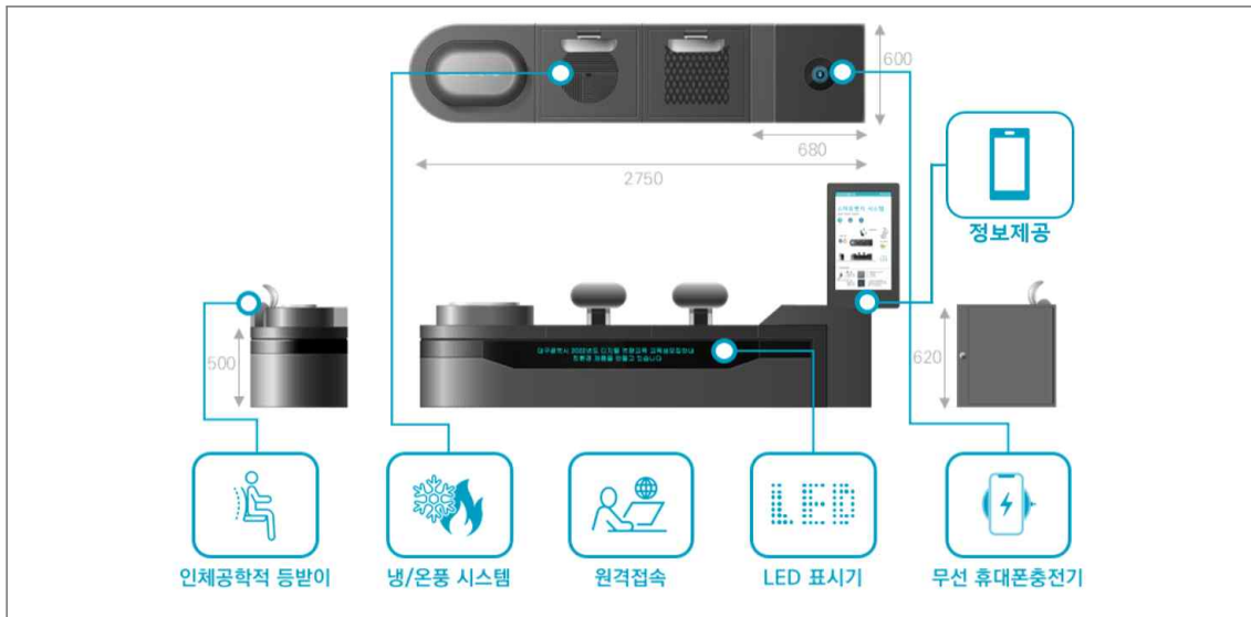
[그림 3-22] 스마트 벤치 시스템 기술성능 및 개념
