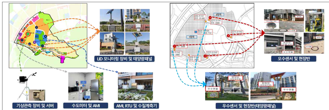
[그림 3-36] 실증단지 내 실시간 수자원 데이터 수집 기술 구축
