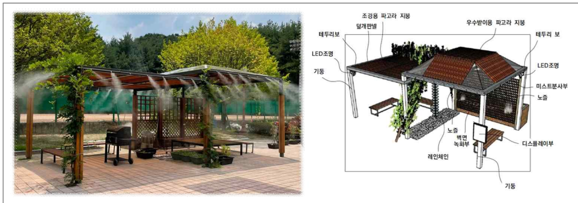
[그림 3-23] 파고라를 이용한 쾌적한 쉼터 설치전경 및 개념도
