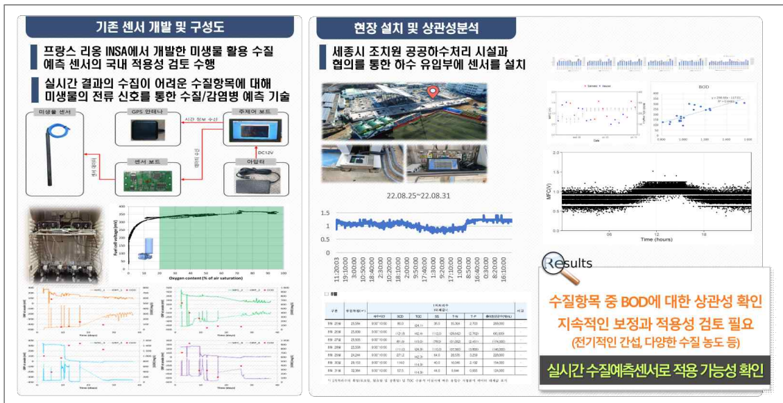
[그림 3-40] 미생물을 활용한 생물학적 수질 예측 센서의 적용성 분석
