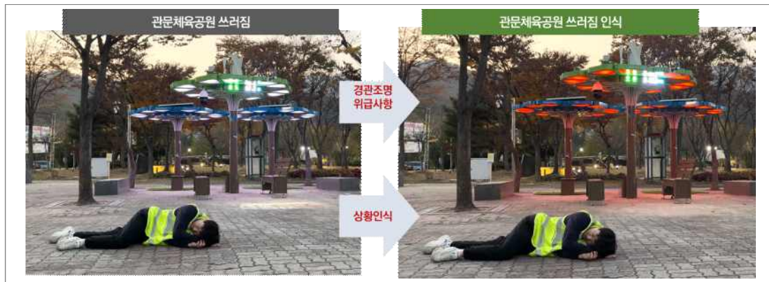
[그림 3-40] 시영상분석 : 쓰러짐 상황인식 테스트
