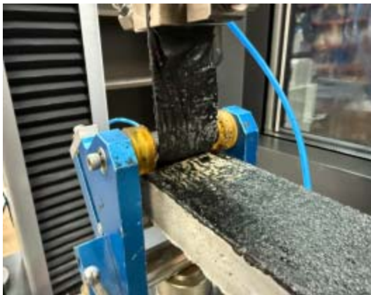
(a) 부착 안정성능 시험 전경
