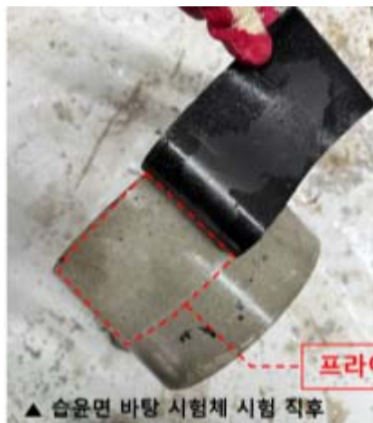
[그림 4-6] 습윤면 바탕 시험체의 프라이머 박리 현상
