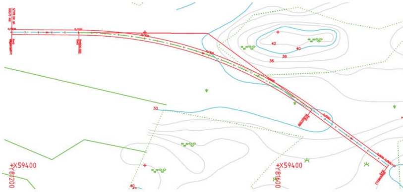
[그림 3-4] 자율주행차량 기준 최소 평면곡선 반경 설계(안)
