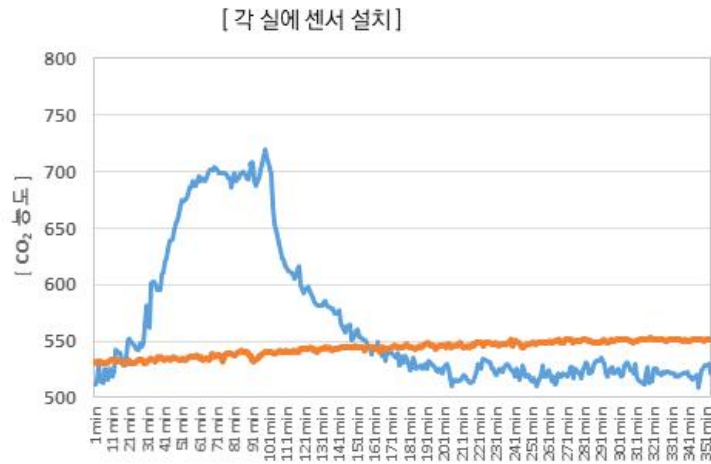
그림 3.4. 각 실에 CO 2 센서 설치 시, CO 2 농도 그래프 추이
