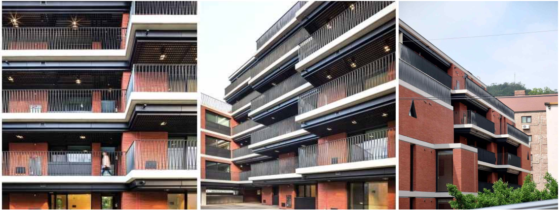
[그림 3-4] 북쪽 배면 북도 난간과 검은색 평철 난간, 바닥층 돌출 및 회색천정 마감
