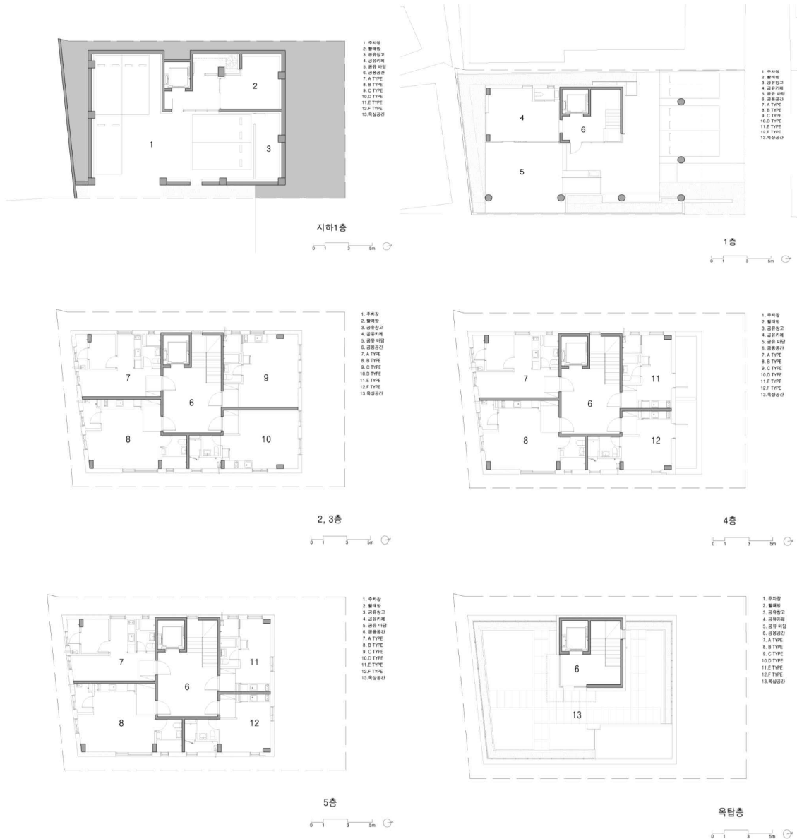
[그림 3-39] 평면도(차례대로 지하 1층: 주차장, 커뮤니티 공간, 세탁실, 지상 1층: 카페, 주차장, 지상 2~5층 세대공간, 옥상: 공유텃밭)
