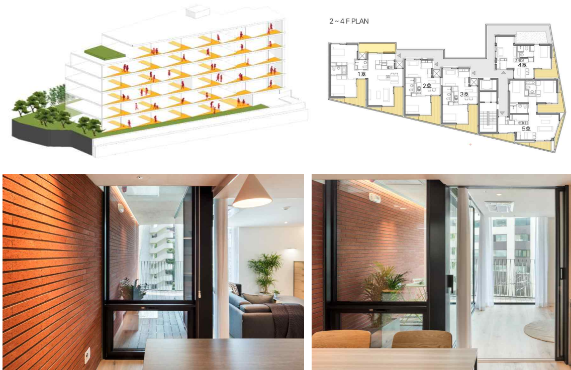
[그림 3-19] 발코니 계획(위 모든 층의 발코니 계획과 4층 평면, 아래 거실 및 침실 측면으로 관입)
