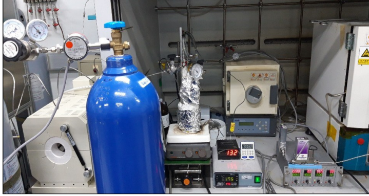
[그림 3-4] Batch-type 촉매 성능 테스트 장치
