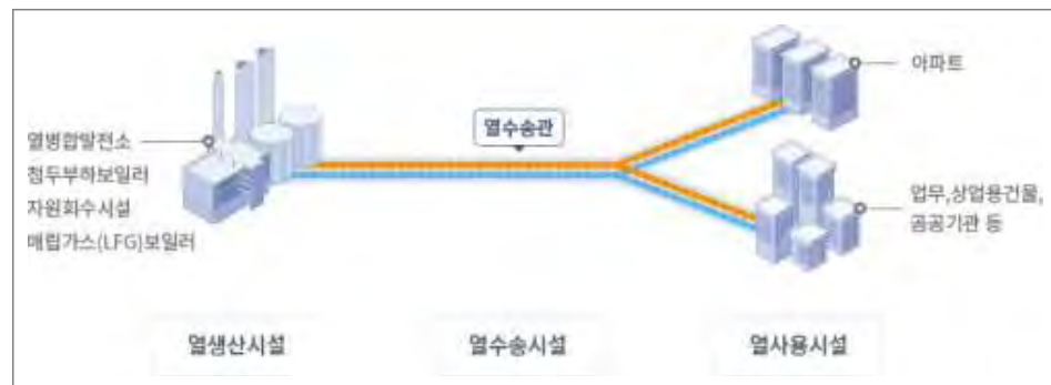
[그림 3-83] 지역난방 방식의 열공급 계통도
