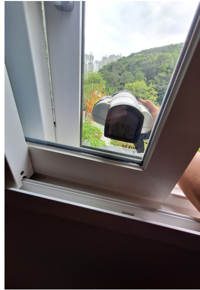
[그림 4.15] 휴대용 알곤측정장치 Gasglass의 측정 방향 설정
