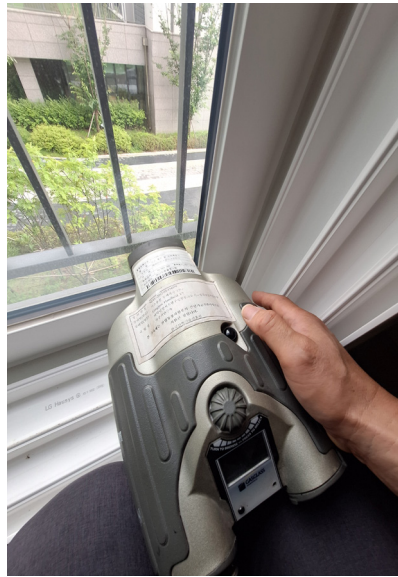
[그림 4.15] 휴대용 알곤측정장치 Gasglass의 측정 방향 설정
