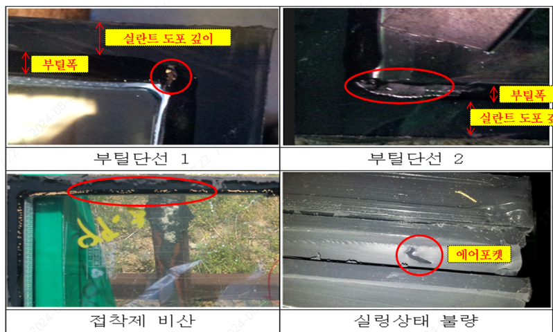
[그림 4.18] 육안으로 확인하는 로이알곤창 불량 사례
