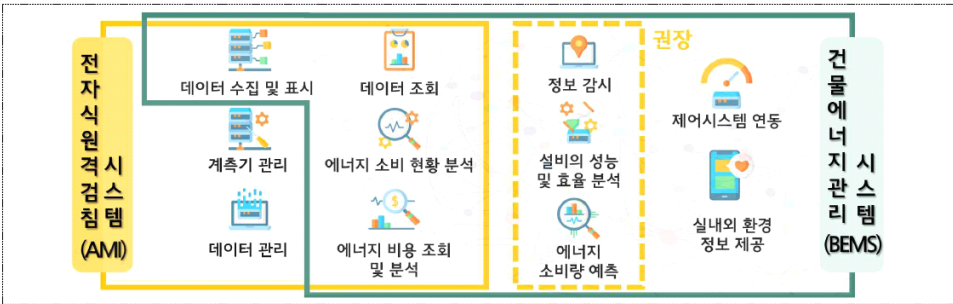
[그림 2.2] 전자식원격검침계량기와 건물에너지관리시스템의 기능비교 (자료출처 : 한국 에너지공단)
