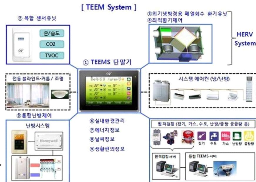
[그림 2.5] 힐스테이트 레이크 송도의 TEEM System 구성도
