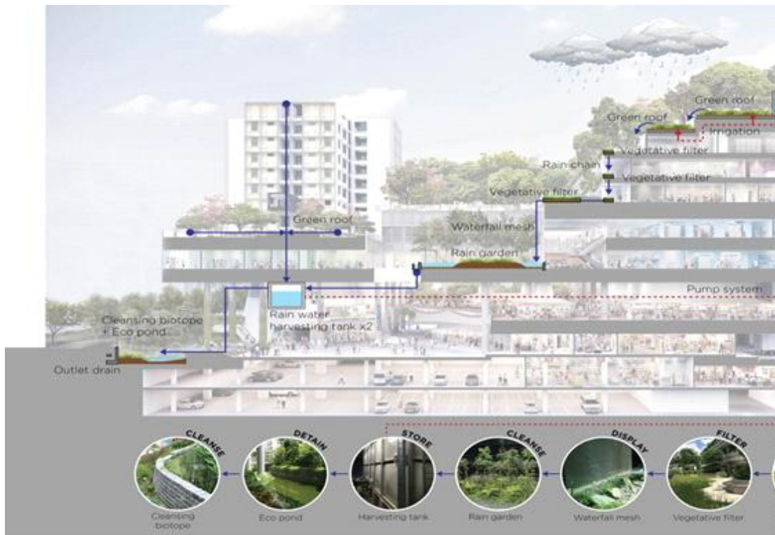
[그림 5-12] 싱가포르 캄퐁 주택의 빗물을 이용한 단지내 용수관리 시스템
