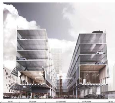
[그림 6-21] 9th Avenue Parkade+Innovation Center-주차장, 중정, 단면구조
