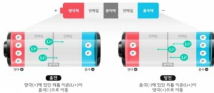
[그림 2-10] 리튬이온배터리 주요 구조
