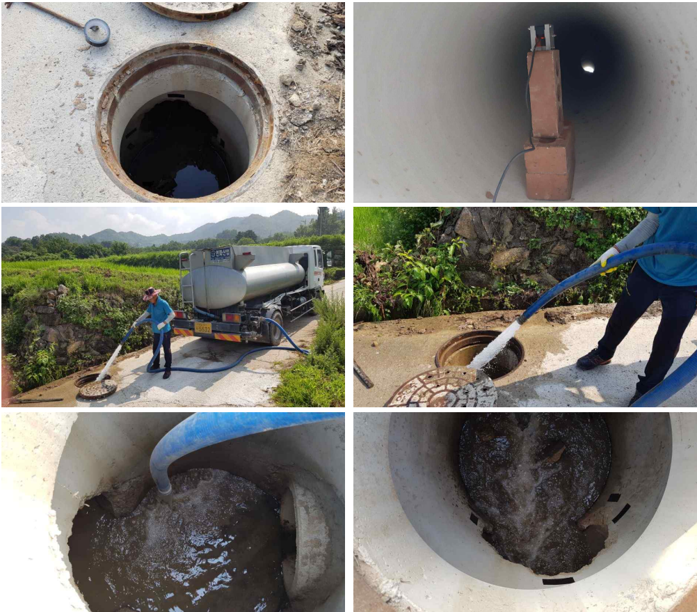
[그림 5-7] 맨홀부 수충격력 실험 수행
