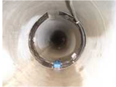
[그림 5-1] 맨홀 내 내충격성 실험(토지주택연구원, 2010)
