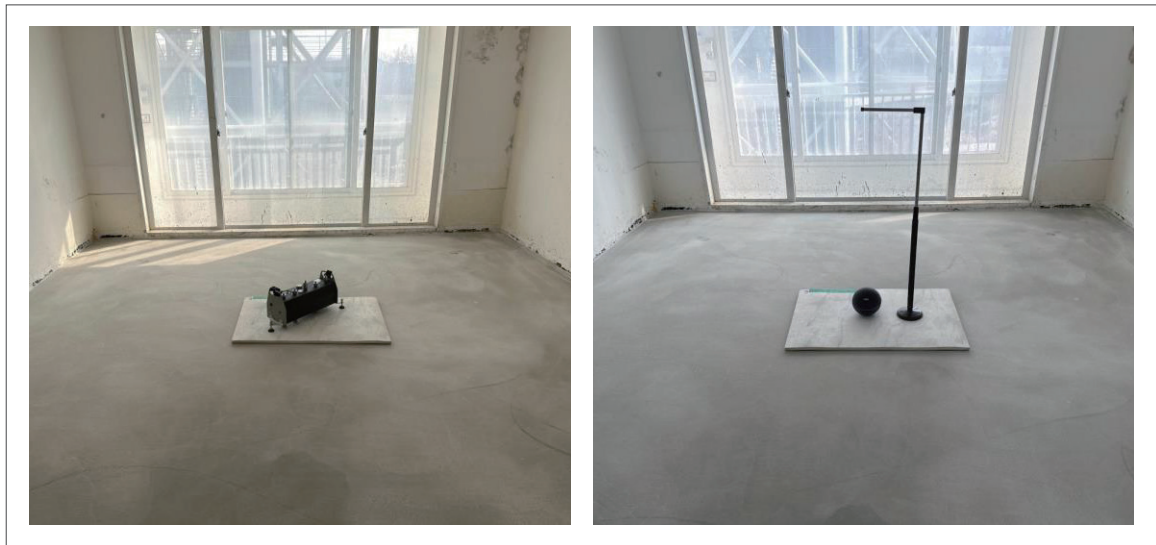
그림-2 층간소음 매트 설치 후 중량, 경량충격음 차단성능 실험 사진
