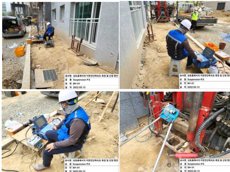
[그림 4.8] 화성 봉담 부유식 음파검층 현장사진
