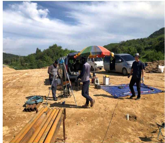
[그림 4.26] 세종 연동면 부유식 음파검층 현장사진
