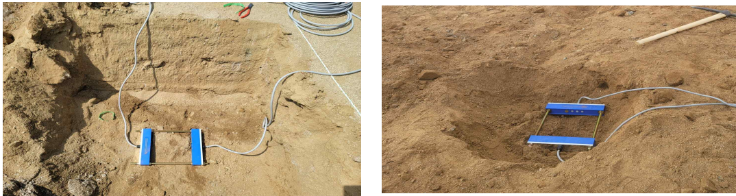
[그림 8.1] 매립형 탄성과 모니터링 장비
