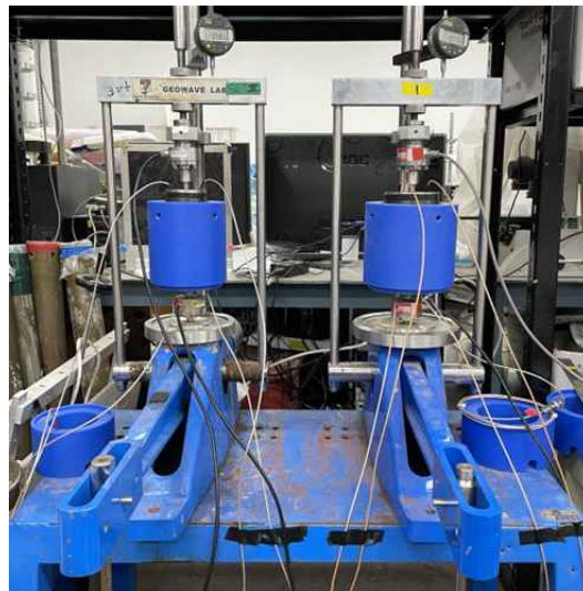
[그림 5.1] 벤더엘리먼트와 연계한 압밀 시험
