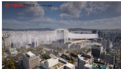
[그림 4-22] 고정밀, 고해상도 3D 맵을 활용한 빌딩풍 분석 시뮬레이션 자료: 테크트리노베이션
