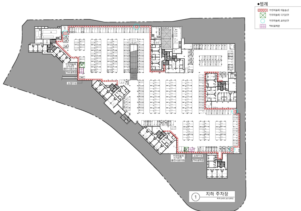
[그림 5-6]로봇배송 서비스 이동 경로 (지하 3개동 마다 물품보관함 배치)
