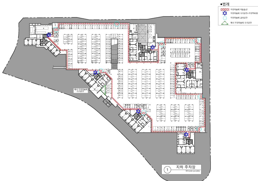
[그림 5-4] 로봇배송 서비스 이동 경로(각 동 지하 물품보관함 배치)
