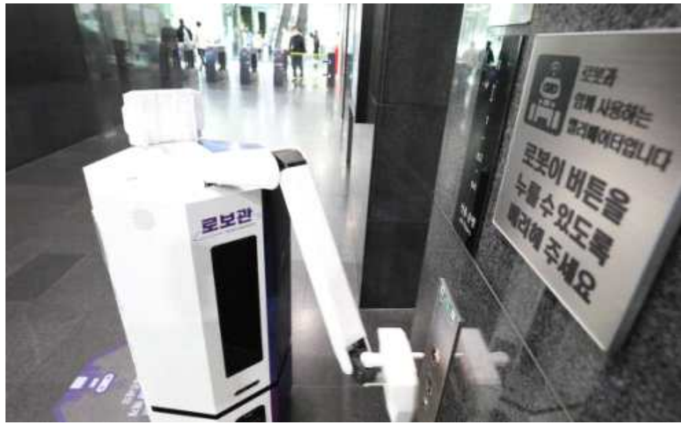
[그림 4-3] 무인배송로봇의 엘리베이터 버튼 조작 모습
