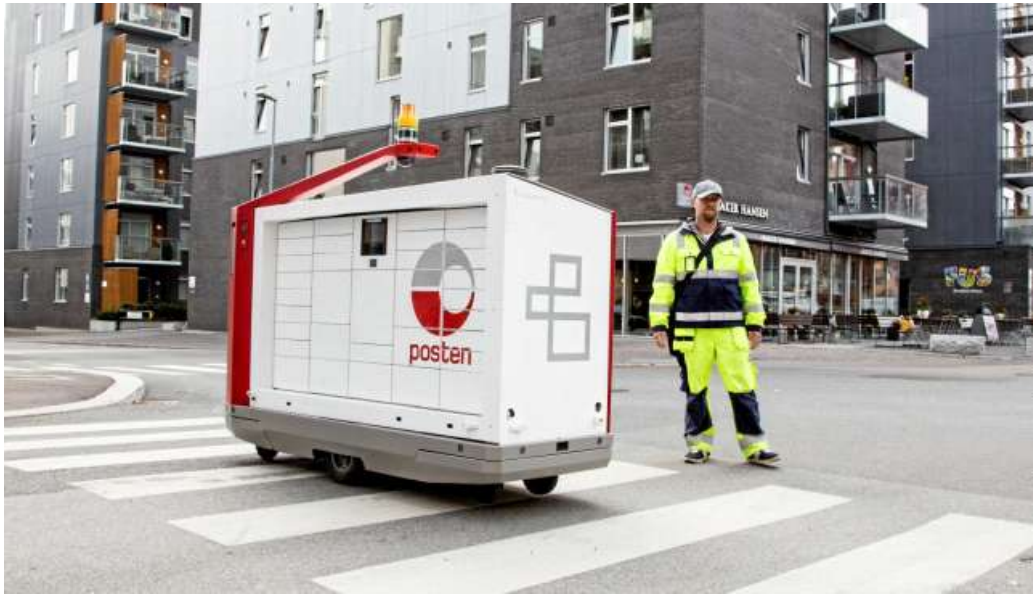
[그림 4-10] Posten Robot사의 택배보관함과 무인배송로봇이 합쳐진 형태의 배송 서비스
