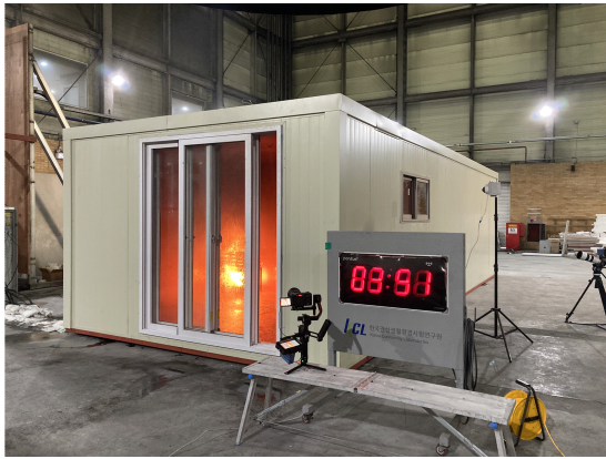
(a) 거실 내 화원 발화(발코니 측)
