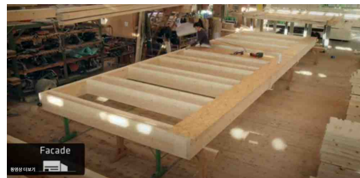
[그림 2-37] LCT one 패널 사전제작 전경 (자료 : CREE)
