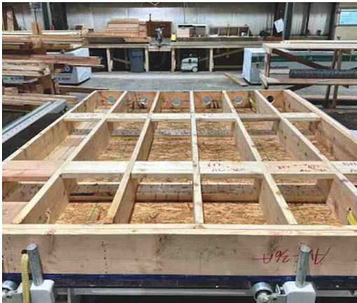
[그림 2-13] 오픈 패널 제작 전경 (자료 : TAG Panels)
