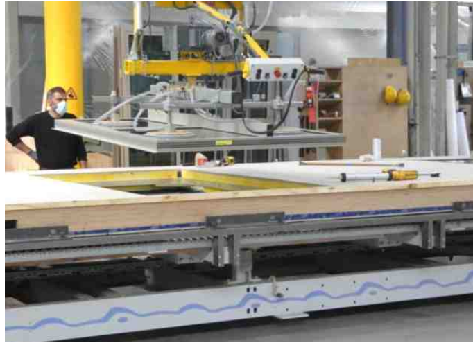
[그림 2-41] Doktoren 클로즈드 패널 창호 자동설치 전경 (자료 : MBS)
