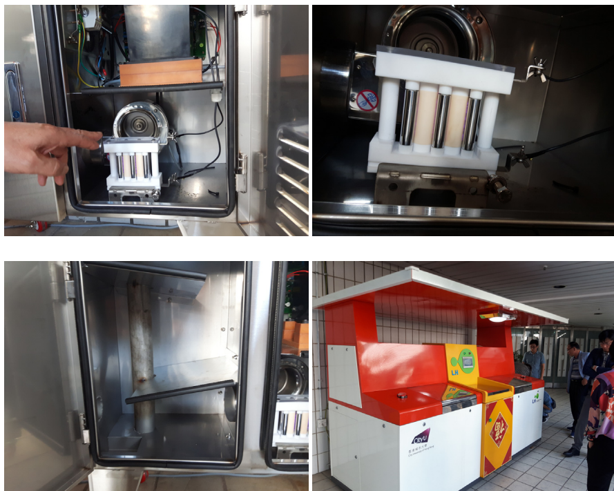
[그림 3-18] 홍콩 City Univ. 음식물 자원화 바이오 시스템 플라즈마 탈취설비
