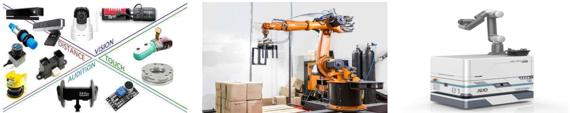
[그림 3-2] 센서 시스템, 매니플레이터, 모바일 모듈(좌로부터)
