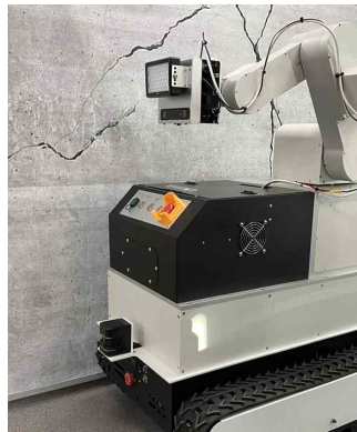
[그림 3-16] 한국건설기술연구원의 터널 크롤러 점검 로봇
