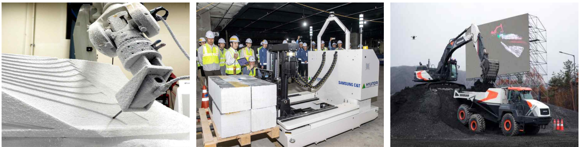
[그림 3-7] 콘크리트 3D 프린팅 로봇, 무인 자재 운반 로봇, Concept-X (좌로부터)
