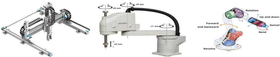
[그림 3-5] 데카르트 로봇, SCARA 로봇, 다관절 로봇(좌로부터)
