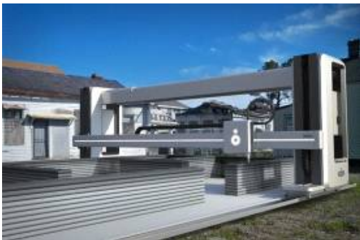
[그림 3-26] ICON 레일형 3D 프린터 장비 및 소형 주택 출력
