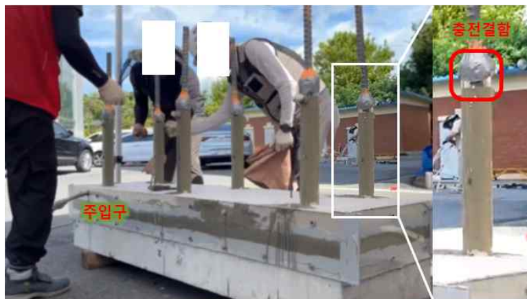
[그림 3-3] PC접합부 그라우트 충전결함
