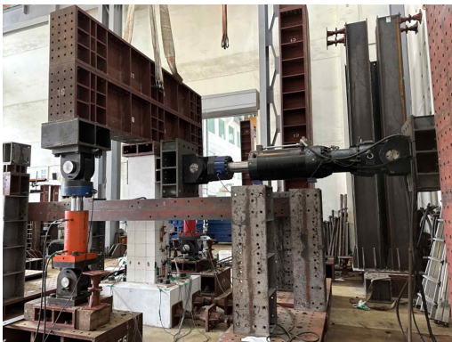
[그림 4-9] PC접합부 구조성능평가 실험체 세팅 사진
